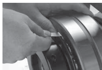
Измерьте радиальный внутренний зазор до монтажа.
