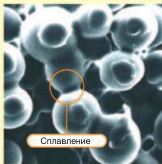
До пропитывания смазкой Соединенные сплавлением частицы полимера.
