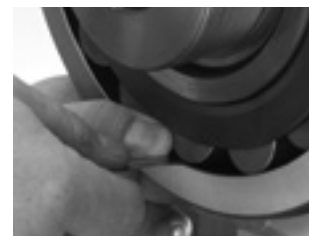
Рис. 15. В процессе монтажа производится проверка РВЗ под ненагруженным роликом.
