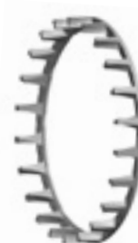
Рис. 7. Механически обработанный разъемный латунный сепаратор пальцевого типа, направляемый кольцом.
