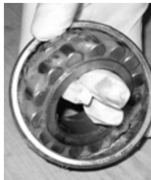
Рис. 21. Пластичная смазка позволяет легко заправить подшипник вручную.
