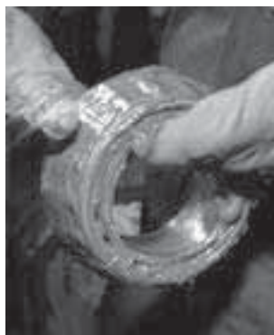
Рис. 23. Пластичная смазка легко позволяет заправить подшипник вручную.
