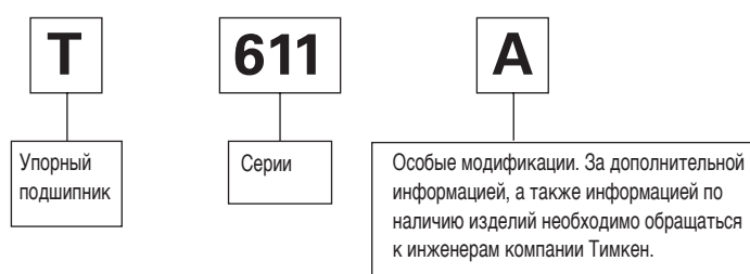
Рис. 41. Система обозначений упорных конических подшипников.
