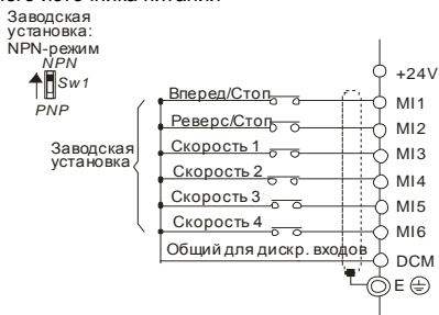
Рисунок 7. Выбор логики управления дискретными входами микропереключателем Sw1.
