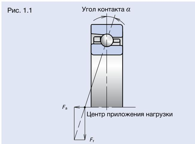
Во время приложения нагрузки на радиально-упорный шарикоподшипник, в результате изменения условий нагрузки шариков, внутреннего и наружного колец в соответствии с углом контакта подшипника, изменяется упругая деформация и степень напряжения в точке контакта.
