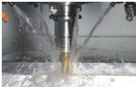
Концевая фреза:  $\phi 16$
