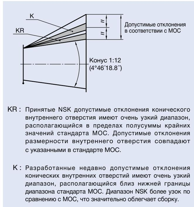
Рис. 7.3 Допустимые отклонения конического внутреннего отверстия
