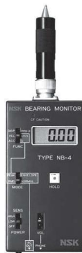
Основной блок NB-4, подсоединенный к ручному вибрационному датчику
