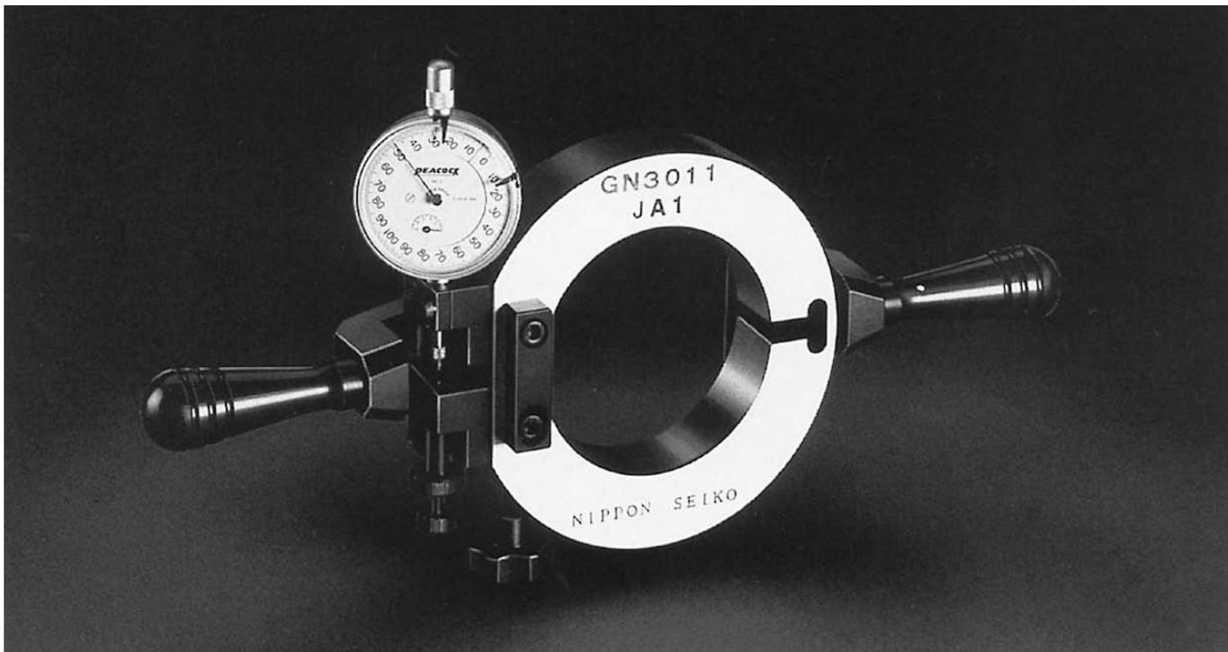
При установке на вал двухрядного цилиндрического роликового подшипника с коническим внутренним отверстием важно сделать так, чтобы конус шпинделя в точности совпал с коническим отверстием подшипника, а также убедиться в том, что после монтажа будет получен желаемый радиальный внутренний зазор.
