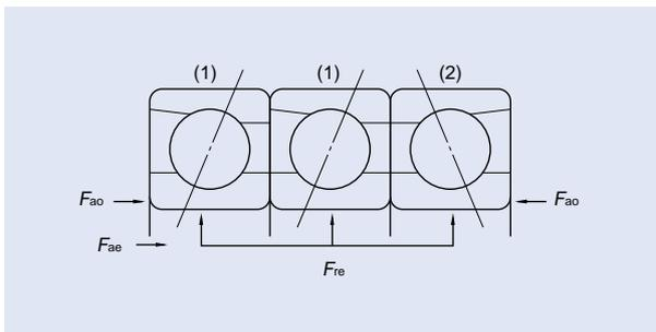
Под приложенной внешней радиальной нагрузкой ( $F_{re}$ ) суммарный преднатяг ( $F_{ap}$ ) рассчитывается следующим образом:
