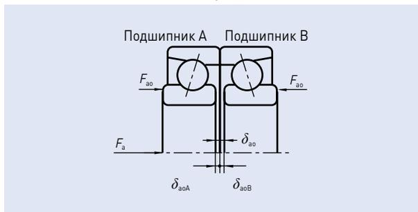
Рис. 4.4 Смещение по оси компоновки DB с преднатягом
