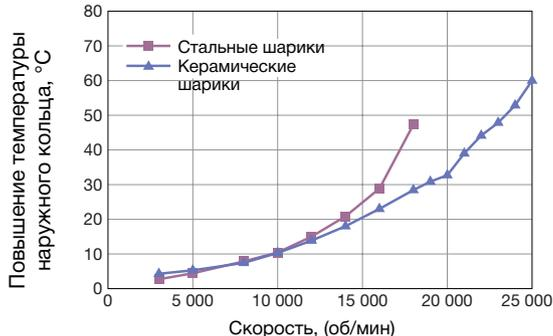
Шпиндель NSK, который достиг 4 миллионов  $d_m n$  при использовании керамических шариковых подшипников
