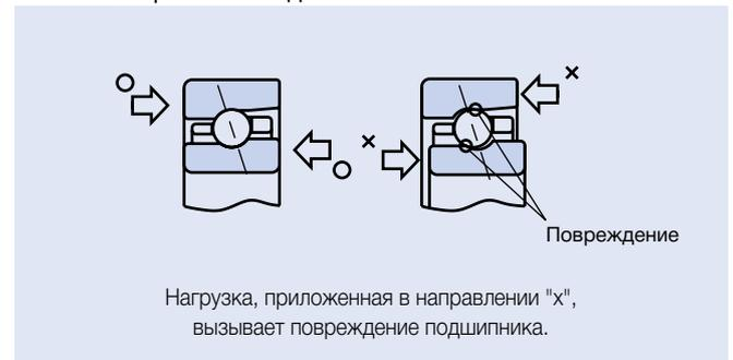
Рис. 1.4 Монтаж компоновки "спина к спине" – 2 подшипника
