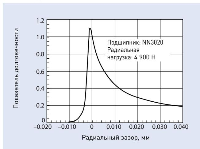
Рис. 4.11 Радиальный зазор в двухрядном цилиндрическом роликовом подшипнике и изменения жесткости
