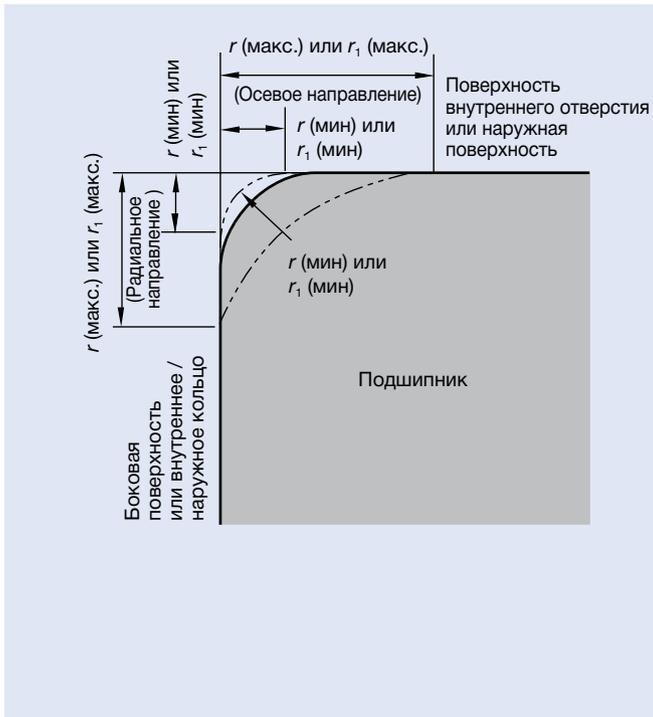
Примечание: Точная форма закругленных поверхностей не устанавливается, но их сечение в осевой плоскости не должно перекрывать дугу радиуса  $r$  (мин) или  $r_1$  (мин), соприкасающуюся с боковой поверхностью внутреннего кольца и поверхностью внутреннего отверстия или с боковой поверхностью наружного кольца и наружной поверхностью.
