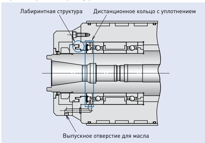
На рисунке слева показана конфигурация с тройным уплотнением – лабиринтное уплотнение, которое состоит из стопорной крышки и дистанционного кольца, внутреннего кольца с первым уплотнением, а также прецизионного дистанционного кольца с дополнительным встроенным лабиринтным уплотнением.
