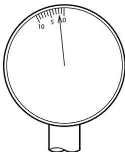
Пример 2: Если стрелка показывает на цифру "2" в направлении против часовой стрелки, то величина радиального зазора равняется -0,001 мм
