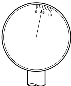
Пример 1: Если стрелка показывает на цифру "4" в направлении по часовой стрелке, то величина радиального зазора равняется +0,002 мм
