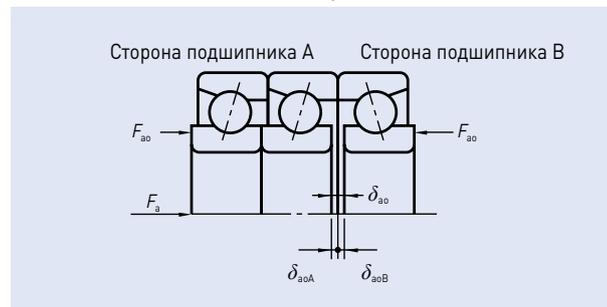
Рис. 4.6 Смещение по оси компоновки DBD с преднатягом
