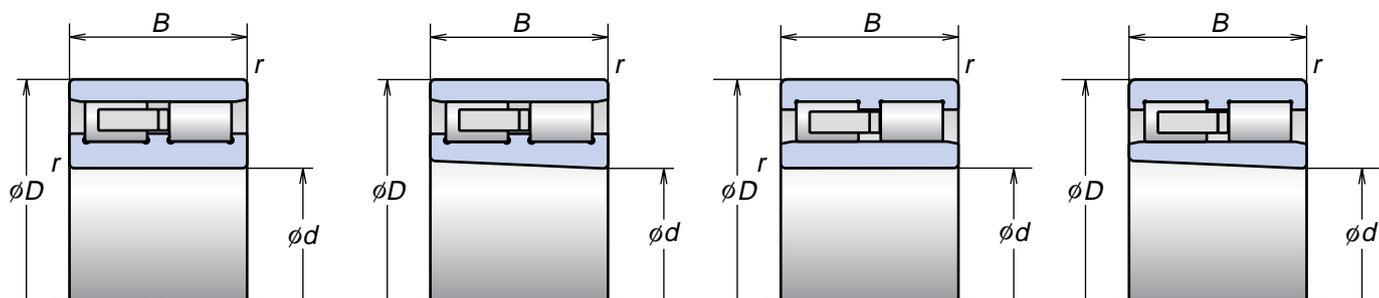
\*NN49 Цилиндрическое внутреннее отверстие
