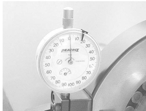
Рис. 1.15 Измерение ширины дистанционного кольца
