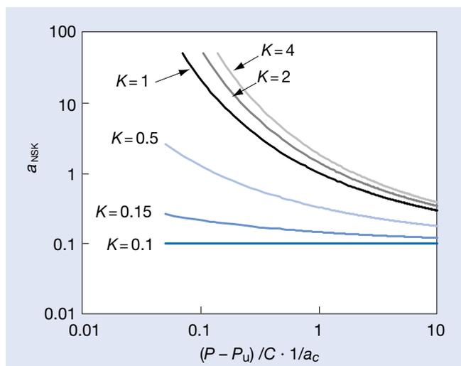
Рис. 1.5 Новая схема расчета долговечности роликовых подшипников
