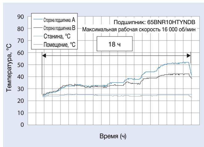
Рис. 3.2 Увеличение рабочей скорости при непрерывной работе
