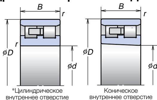
\*Цилиндрическое внутреннее отверстие
