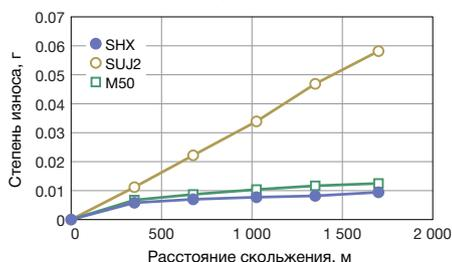
Испытание на износ двух цилиндрических роликов
