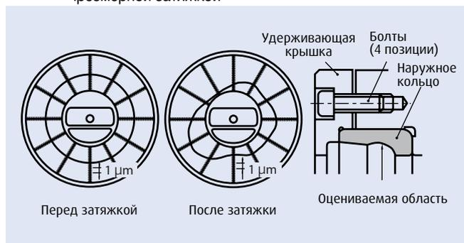
Рис. 1.7 Деформация поверхности дорожки качения, вызванная чрезмерной затяжкой
