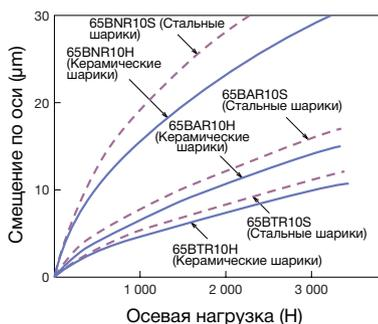
Механообработка шпинделем NSK при использовании шарикоподшипников с керамическими шариками
