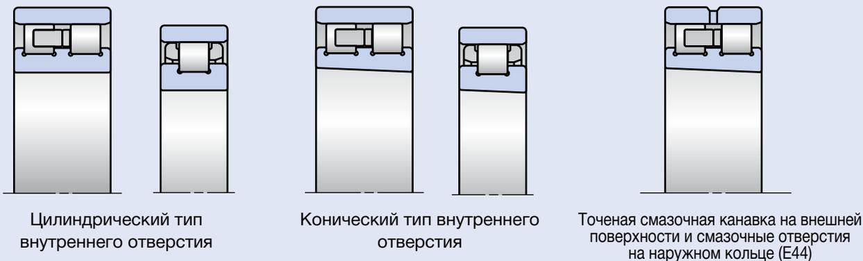
Двухрядные и однорядные подшипники, выпускаемые с цилиндрическим или коническим внутренним отверстием. Двухрядные цилиндрические роликовые подшипники, выпускаемые с проточенными смазочными отверстиями и смазочной канавкой (лучшее решение для смазывания жидким смазочным материалом).
