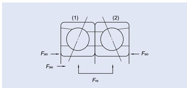
Под приложенной внешней радиальной нагрузкой ( $F_{re}$ ) суммарный преднатяг ( $F_{ap}$ ) рассчитывается следующим образом:
