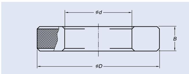
Для того, чтобы прецизионные подшипники качения для шпинделей станочного оборудования приобрели удовлетворительные рабочие характеристики, важно, чтобы они имели точную посадку в отношении вала и корпуса. Для достижения точной посадки необходимо точно измерить наружный диаметр вала и внутренний диаметр корпуса.
