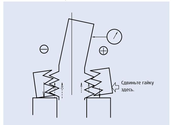
Рис. 1.22 Точность обработки шпинделя механического станка
