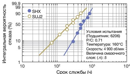
Испытание на поверхностное отслаивание частиц
