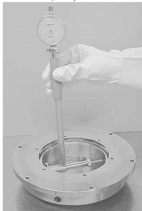
Рис. 1.11 Регулировка вписанного диаметра калибра GN
