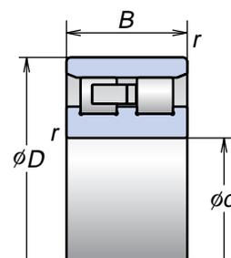
\*Цилиндрическое внутреннее отверстие
