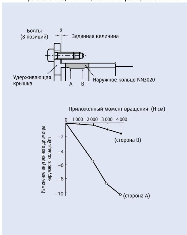
Таблица 1.1 Момент затяжки контргайки подшипника и зазор между крышкой и корпусом.
