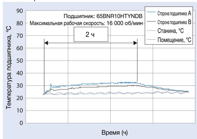
Рис. 3.4 Один цикл приработки в прерывистом режиме
