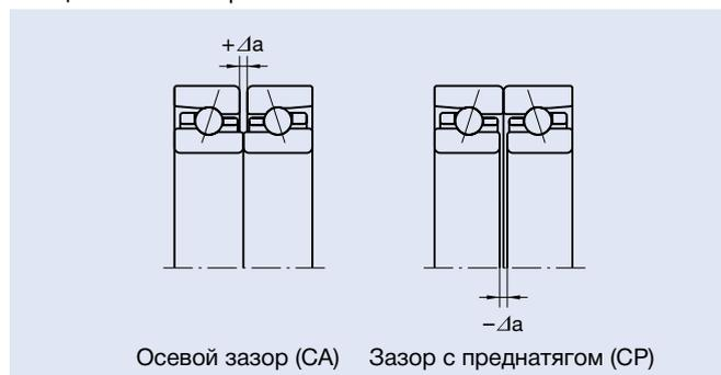
Осевой зазор (CA)      Зазор с преднатягом (CP)
