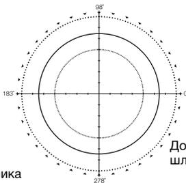
Допуск на округлость шлифуемой заготовки
