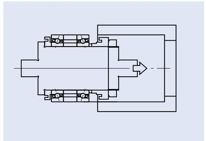
Рис. 1.5 Монтаж компоновки "лицо к лицу" – 2 подшипника
