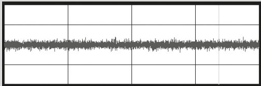
Рис.1 – Форма звукового сигнала исправного подшипника
