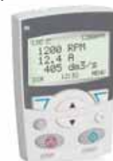
Базовая панель управления
